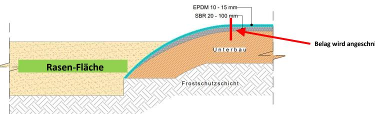
Belag wird angeschnitten; kompletter Belag auf Schräge wird entfernt
